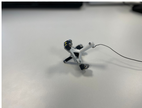
Figur 4.1: Modifierat printer-huvud med en passiv pekpena
